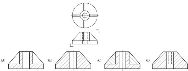
18 採用第三角法繪製一物體的正投影視圖的前視圖、俯視圖和右側視圖,該物體含有幾個複斜面?
