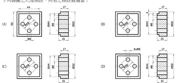
12 根據國家標準(CNS),已發出之圖須更改時,更改尺度之標註方式,下列何者正確?
