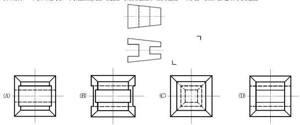
22 採用第三角法繪製一物體正投影視圖的前視圖和俯視圖,何者為正確之右側視圖?
