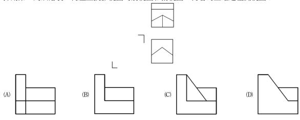
26 採用第三角法繪製一物體正投影視圖的前視圖和俯視圖,何者為正確之左側視圖?
