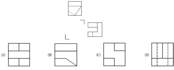
25 採用第三角法繪製一物體正投影視圖的前視圖和俯視圖,何者為正確之左側視圖?
