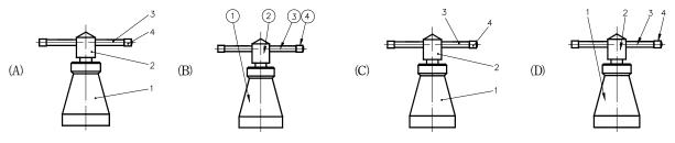
31 下圖將對稱圖形以半剖面表示,那一個圖關於孔徑的標註法正確?
