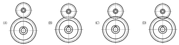
21 採用第三角法繪製一物體正投影視圖的前視圖和俯視圖,何者為正確之右側視圖?
