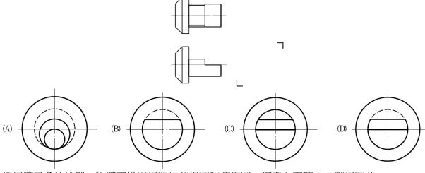
23 採用第三角法繪製一物體正投影視圖的前視圖和俯視圖,何者為正確之右側視圖?
