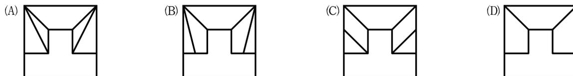
16 下列圓柱軸孔組套件之剖視圖，何者畫法最正確？
