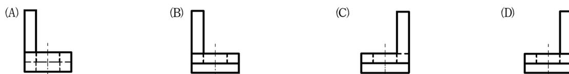
27 採用第三角投影法繪製一物體正投影視圖，已知該物體的前視圖與左側視圖，如下圖所示，請選出正確的俯視圖。
